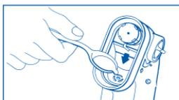
2. Inserite un cucchiaino (4 ml) d'acqua demineralizzata o potabile nella zona del trasduttore.
