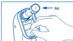
8. Asciugate la zona del trasduttore con una garza sterile senza esercitare inutile pressione sul trasduttore stesso. Se il coperchietto trasparente (A6) appare umido o sporco, sfilatelo e procedete alla pulizia anche del dischetto sottostante.
