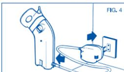
4. Collegate il nebulizzatore alla presa di rete elettrica mediante l'apposito alimentatore come indicato (fig. 4), lo stesso deve essere posizionata in modo tale che non sia difficile operare la disconnessione dalla rete elettrica.
